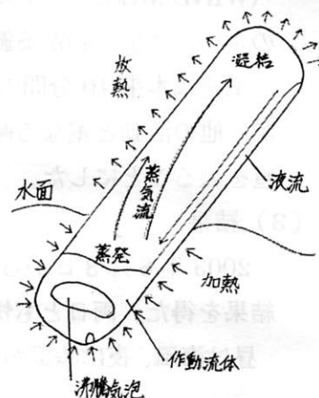
図1 ヒートパイプの原理
