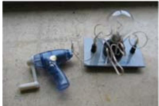
自転車発電では比較的容易に100Wの電力を得ることができる。一方、ハンドジェネレーター1個の発電力では、100W電球をわずかに点灯させることしかできない。そのため、数個のハンドジェネレーターを直列に接続することで、発電力を増幅させることができる。
