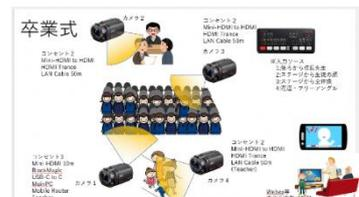
図2 配信場面による機材セット例
